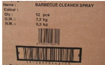
Слика 7.5 Пример трговинске јединице са два различита GTIN-а
