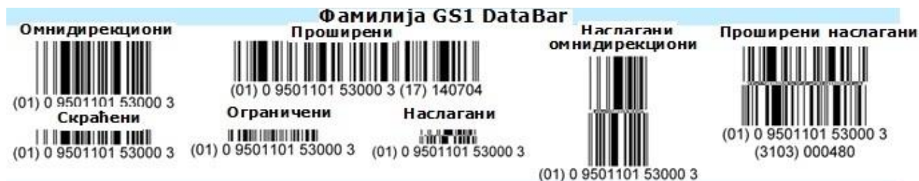
Слика 5-16 Преглед фамилије GS1 DataBar кодова (није стварна величина слика)
