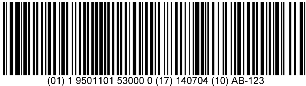
Слика 2-2 Пример GS1-128 бар кода који представља GTIN са датумом „најбоље употребити до“ и бројем лота
