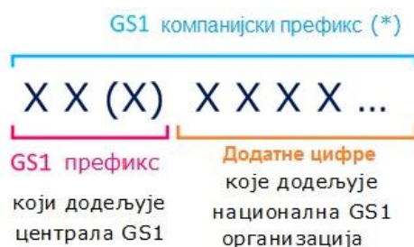
Слика 3-2 Структура GS1 компанијског префикса
