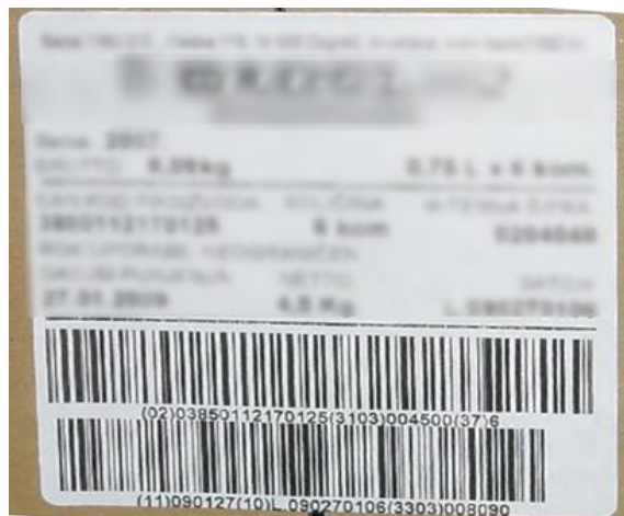
Слика 7.6 Пример неправилне употребе AI (02) и (37) (пошто нема AI (00) SSCC)
